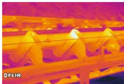
*Image visible et image thermique d'un roulement à billes qui surchauffe et devrait être remplacé.*
