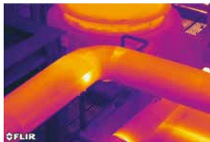
*L'image thermique montre un défaut d'isolation des canalisations. Cela peut interrompre le processus de production et provoquer des accidents graves.*
