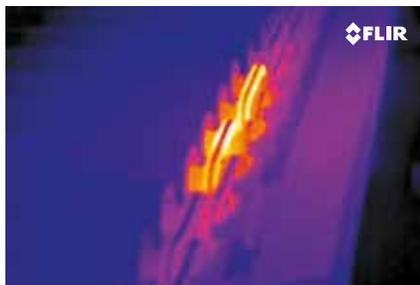
*Image visible et image thermique de rouleaux surchauffés d'un tapis convoyeur.*
