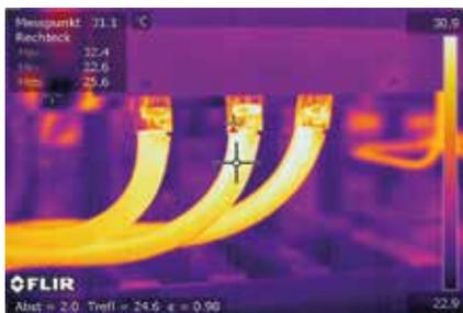
Image thermique de câbles électriques.
