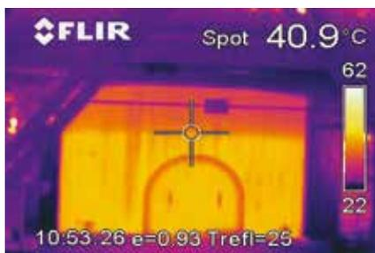
La détection du niveau de remplissage des réservoirs est une des applications de l'imagerie thermique chez BASF.
