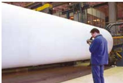
Inspection de la répartition de l'humidité dans le papier, qui défile à une vitesse de 1600 m/min.
